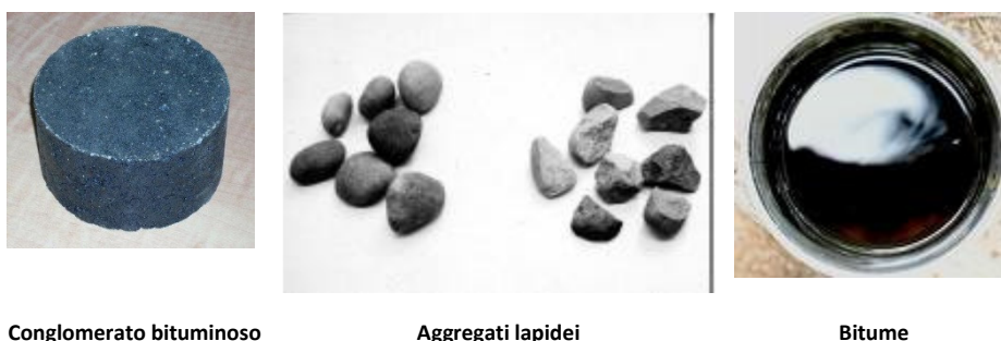
Figura 3: Costituenti conglomerato bituminoso
